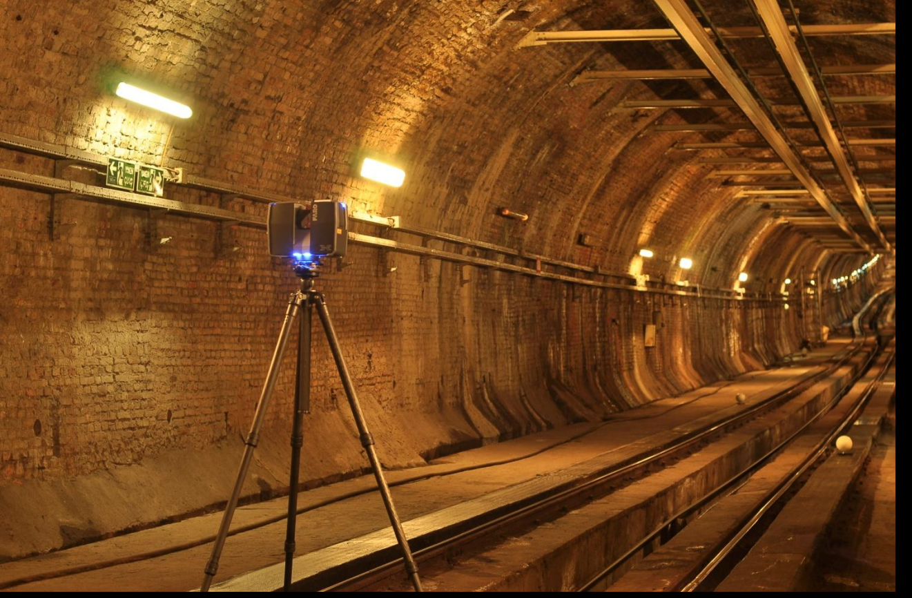
Beyoğlu-Karaköy Arası Tarihi Tünel Deformasyon Ölçümü
