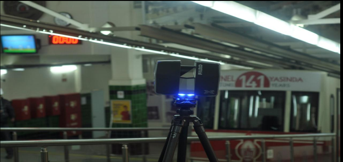
Beyoğlu-Karaköy Arası Tarihi Tünel Deformasyon Ölçümü
